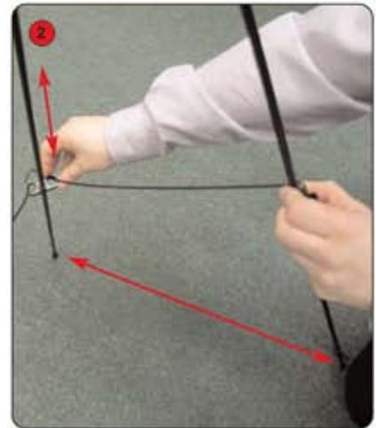
2 Sistema la gamba posteriore portante dietro alle gambe anteriori in modo da creare una struttura stabile. Sistema i tiranti alla giusta altezza per fissare la struttura.
